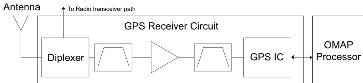
Figure 3-6. GPS Diagram
