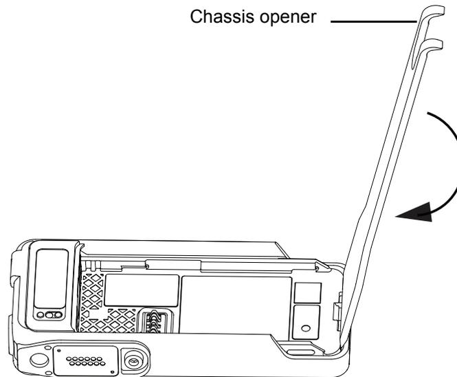
*Figure 8-6. Disengage the Chassis*
